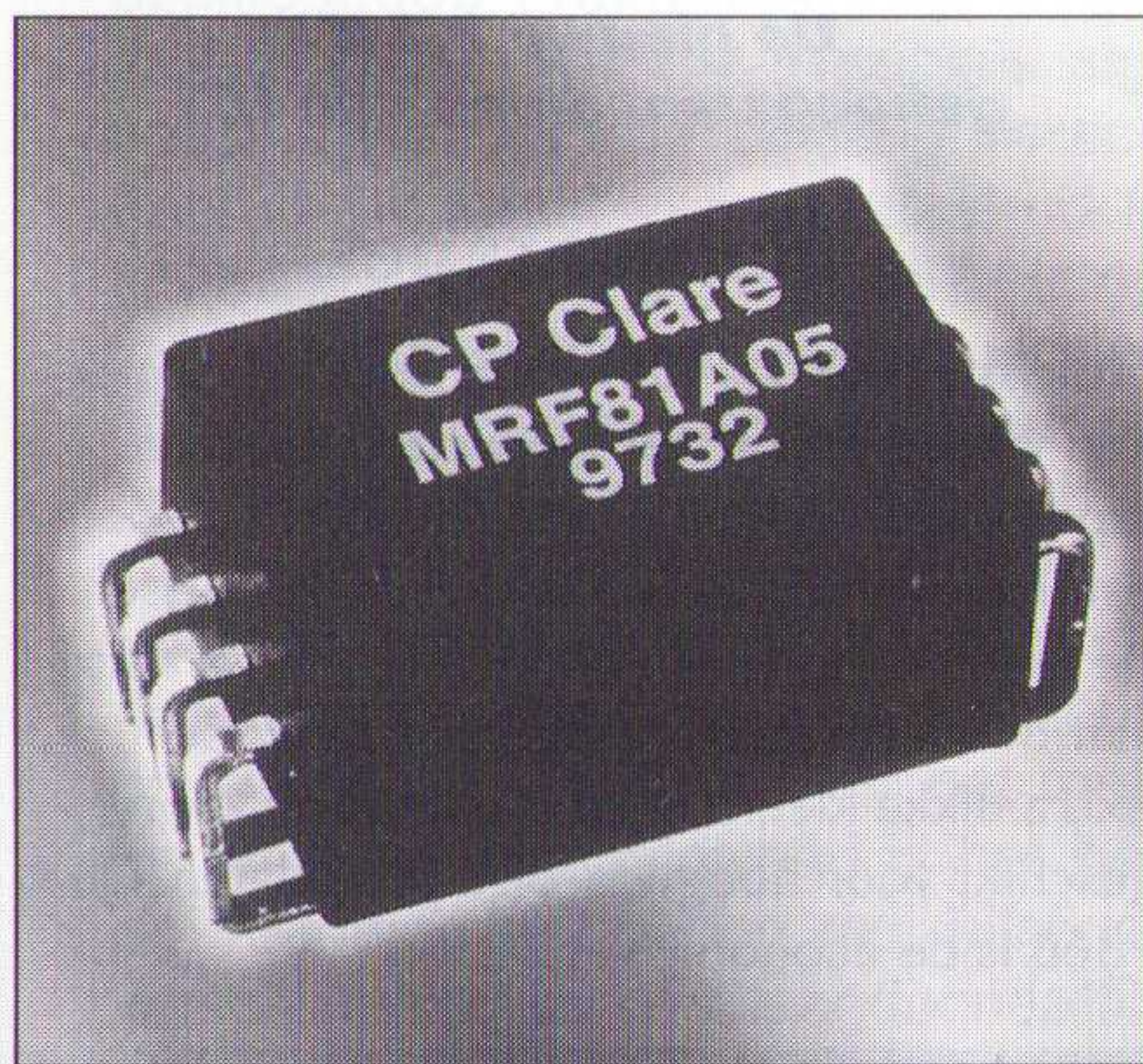
De kleinste SMD-relais kennen een levensduur van 200 miljoen bewerkingen op een laag signaalniveau.
