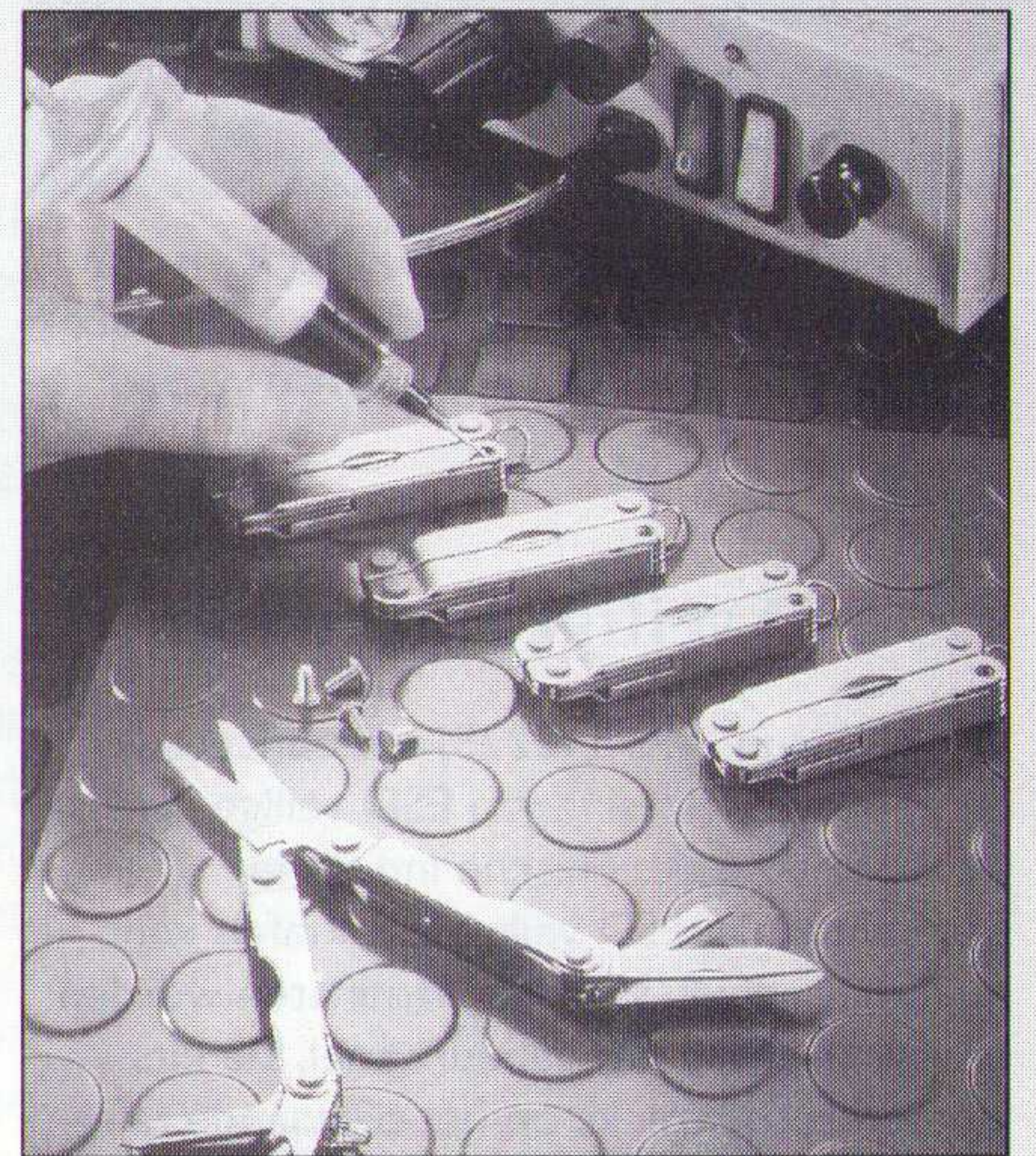
De controle van de dosering door het nieuwe doseerapparaat geeft een hogere betrouwbaarheid en reproduceerbaarheid.
