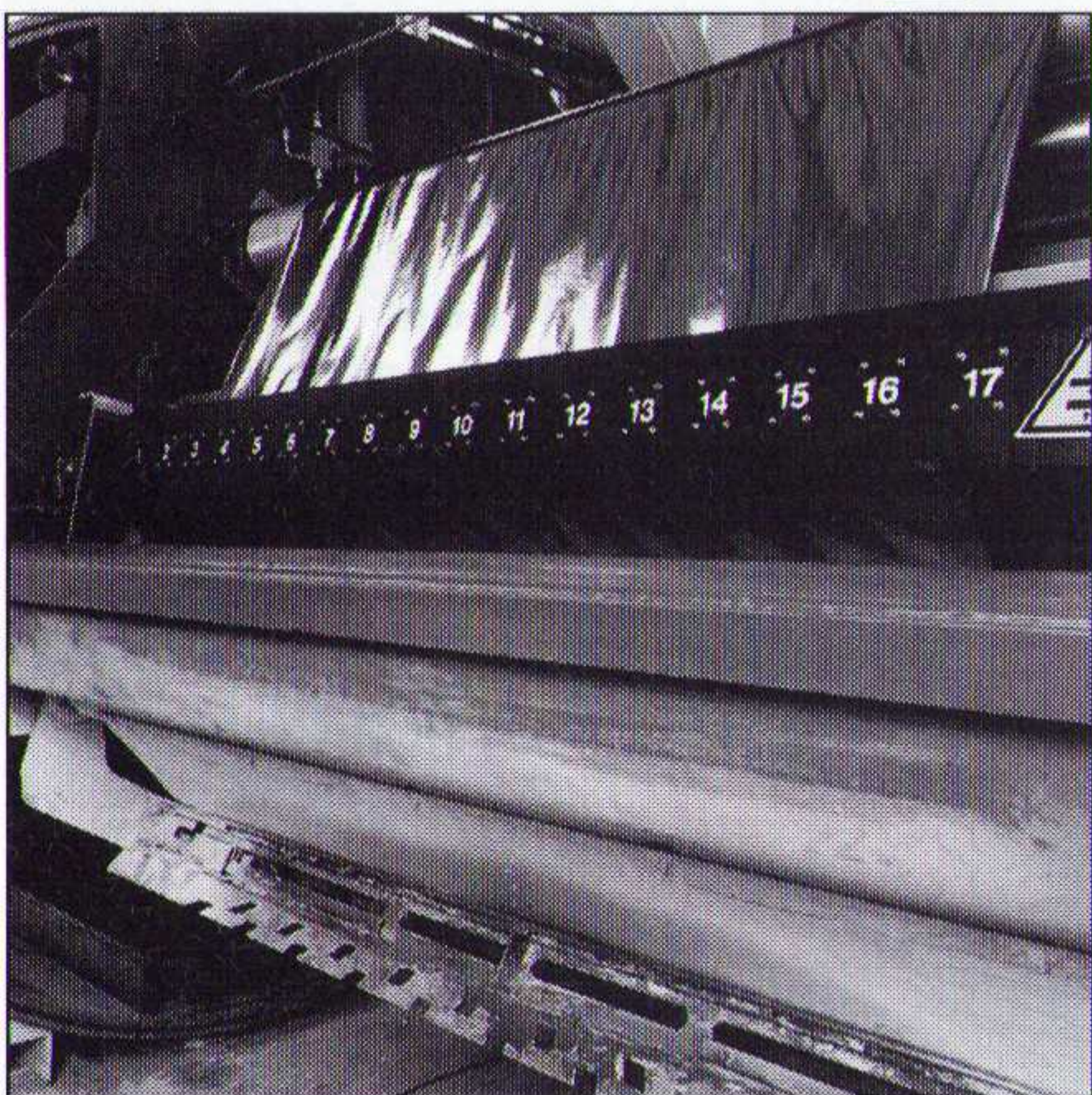
In het midden van de foto is het aluminium profiel zichtbaar waarin zeventien wervelstroomsensoren zitten gemonteerd. Ook is het gemetalliseerde papier zichtbaar.
